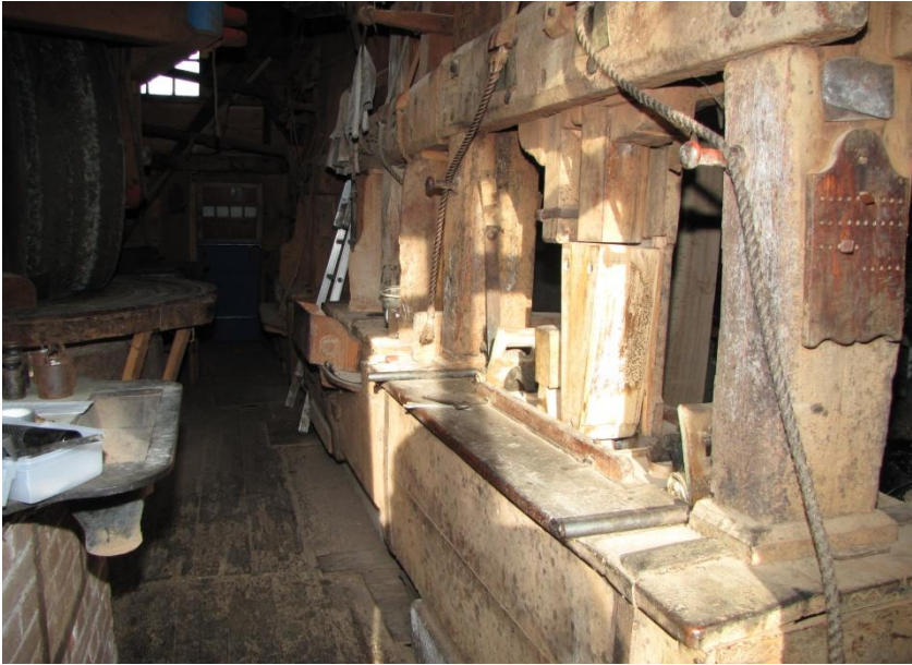
Het slagblok met heien en stampers
